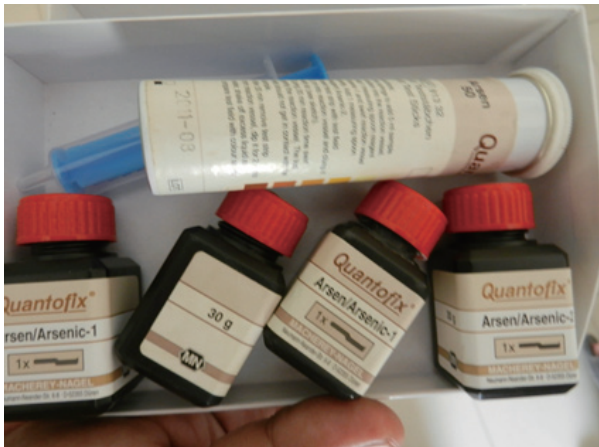
ヒ素試験キット (水質試験室)
