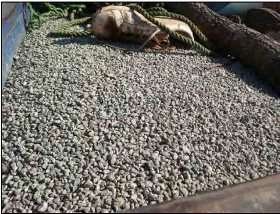
写真3 現地掘削業者が準備したグラベル
