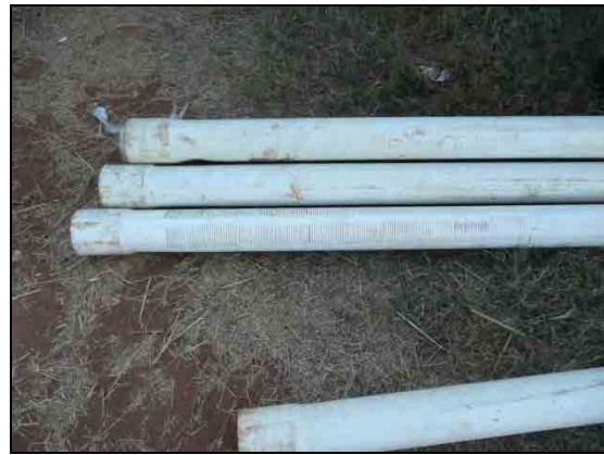
写真4 現地掘削業者が準備した井戸用PVC 4インチケーシングとスクリーン
