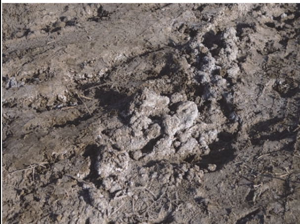
塩分の析出 地下水位観測孔付近には塩分の蓄積がみられる
