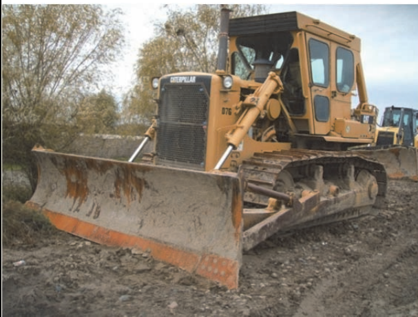
ブルドーザ(20トン) クラ川築堤工事に従事中、8,000時間稼働 (フェーズ1調達機材)
