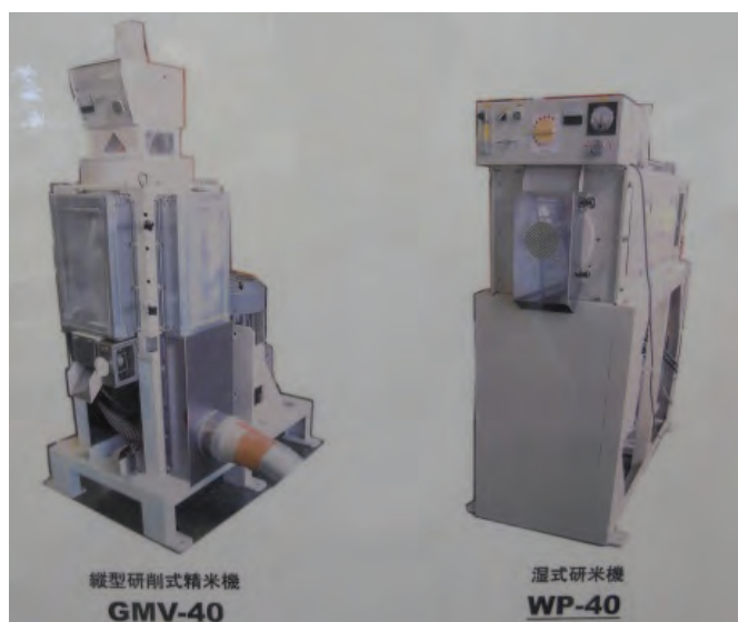
写真：縦型研削式精米機と湿式研米機（3トン機）
