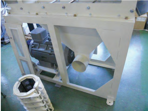
形鋼・製缶の例（精米機の土台の部分）
