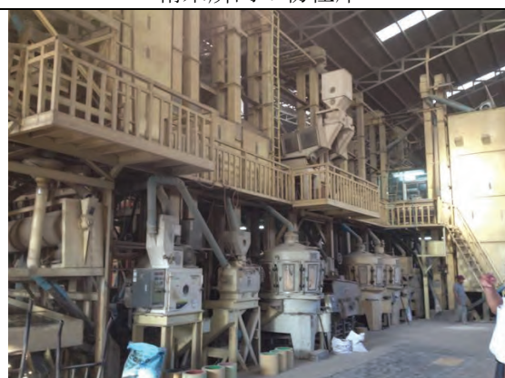
中堅精米所の精米プラント (4-5 トン/時)
