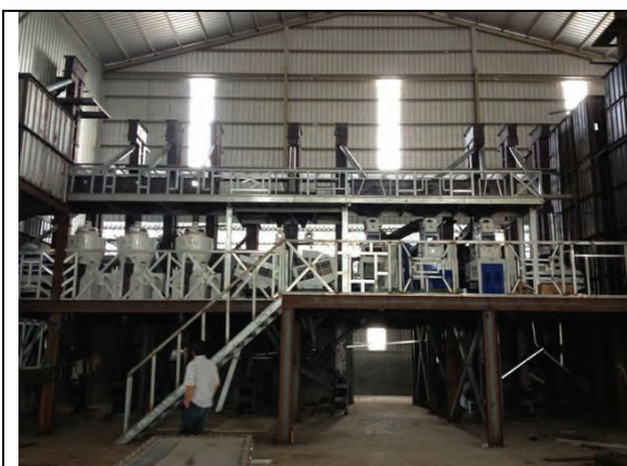
新規の大規模精米所の精米プラント (10トン/時)
