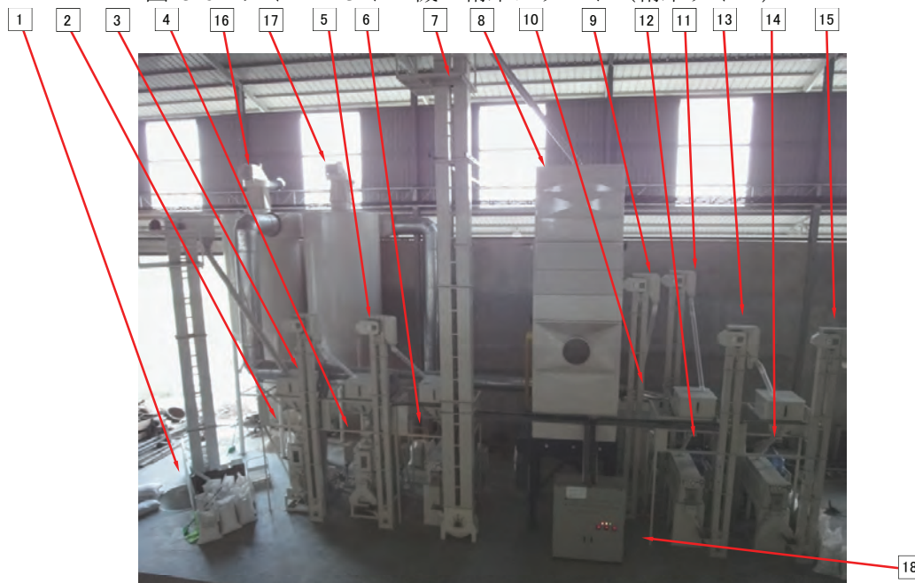
図 5-6：タイワの3トン機の精米プラント（精米ライン）
