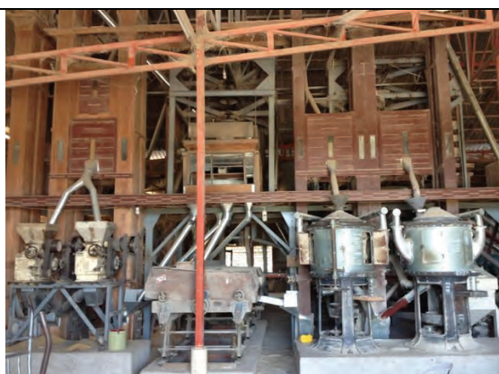
中小精米所の精米プラント (1-2 トン/時)
