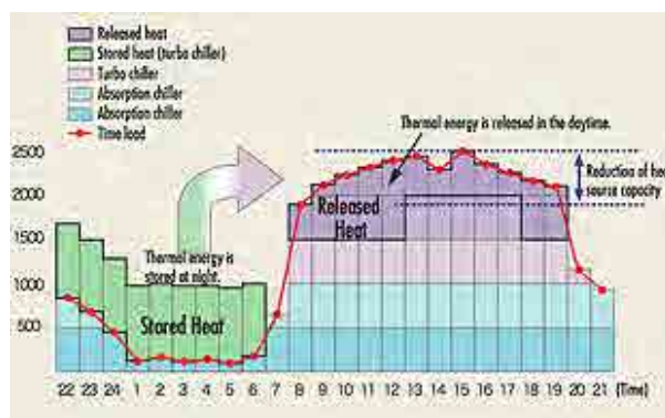
図 5.3-7 蓄熱設備運転概念図（森ビル）
