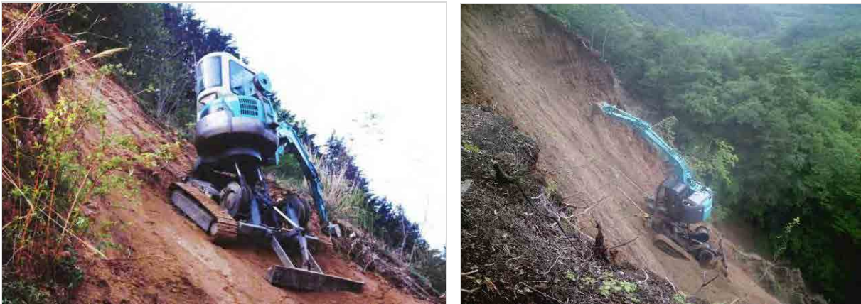
Figura 2-38 Excavadora de talud para lugares altos (máquina rock climbing)
