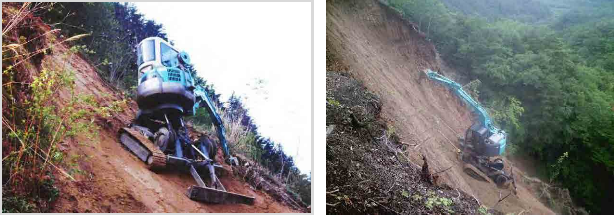
図 3-38 高所法面掘削機（ロッククライミングマシン）
