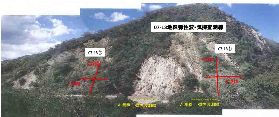
図 2-31 07-18 地区弾性波・電気探査位置
