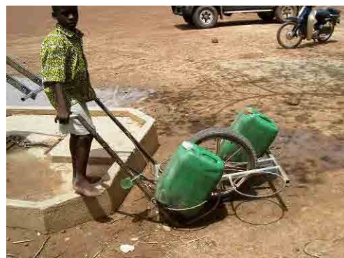
写真-12 水運搬用手押し車 現地の町工場製の水運搬用一輪車 (手押し車) が市販されている。80ℓ ~120ℓ が運搬できる。
