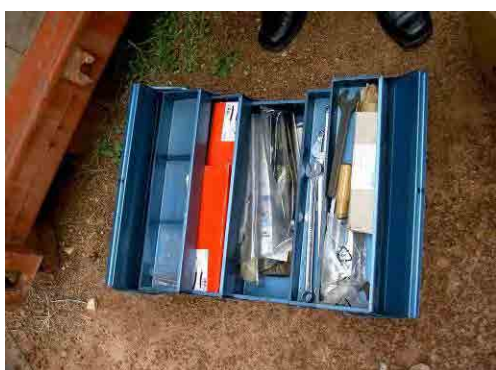
写真-15 Kardia 人力ポンプの修理人用工具 ドイツ製 Kardia 人力ポンプとドイツ製 India-Mk II の販売代理店である HYDRASS-BURKINA 社が、研修を受けた修理人に配布している人力ポンプの修理工具。
