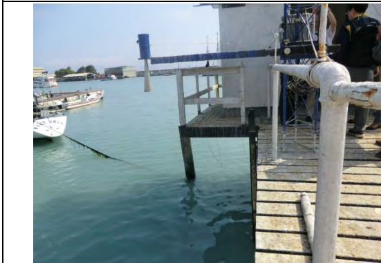
既存の潮位計（カヤオ） DHN 本部近くの既存超音波潮位計。測定データは GOES に接続されてハワイ大学や IOC に提供される。
