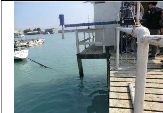
既存の潮位計（カヤオ） DHN 本部近くの既存超音波潮位計。測定データは GOES に接続されてハワイ大学や IOC に提供される。
