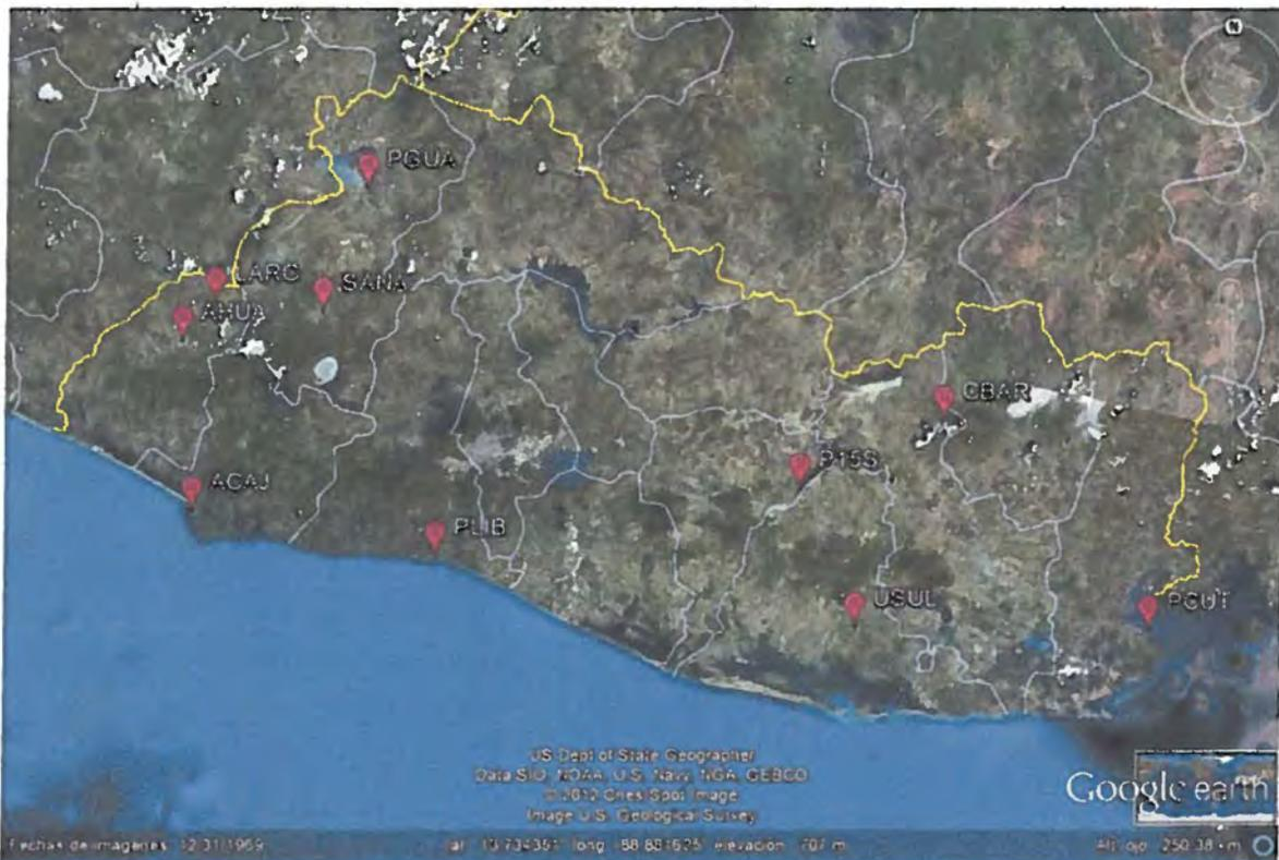
Figura 2: Los lugares propuestos para instalar nuevas estaciones de GPS
