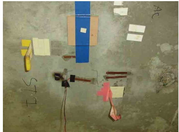
チュラロンコン大学による載荷試験 (25t) のゲージ類
