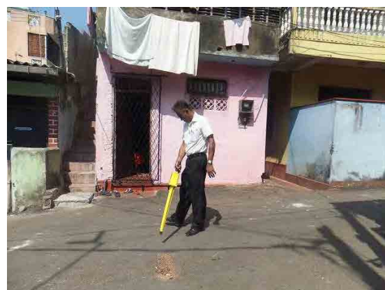
パイロット活動（Kotahena） （漏水調査）
