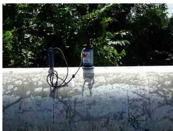
パイロット活動 （大口径管漏水探知方法のトレーニング）
