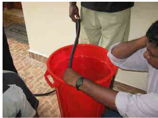
Borella メーター精度調査
