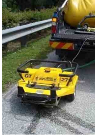
図 5-37 マレーシアに導入されている Grip Tester の例
