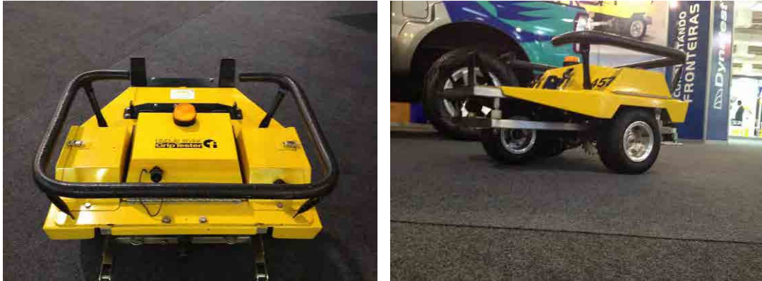
図 5-52 ブラジル・Dynatest 社のグリップテスターの例
