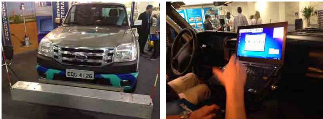
図 5-50 ブラジル・Dynatest 社の路面性状測定車の例
