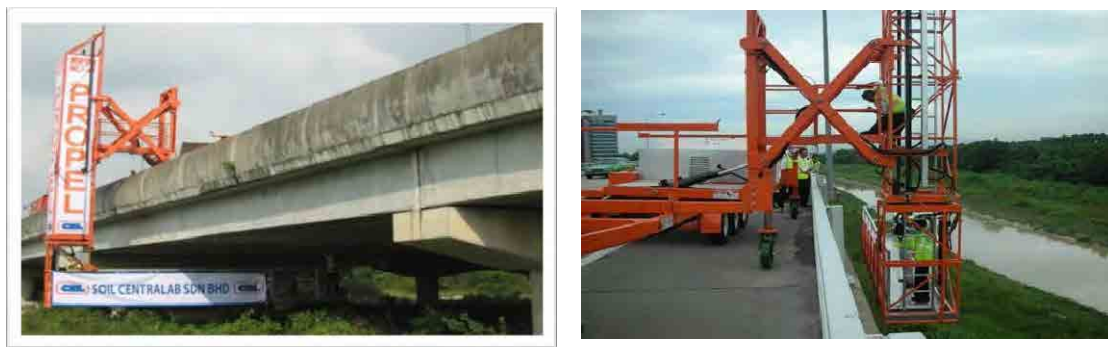
図 5-39 マレーシアに導入されている橋梁点検車の例
