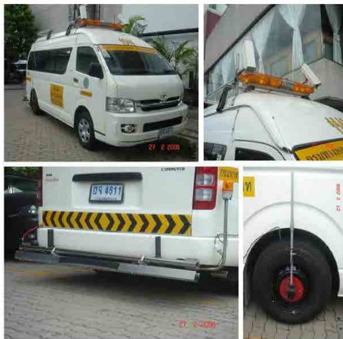
図 5-43 タイで独自に開発された路面性状調査車 (Rosy Car)
