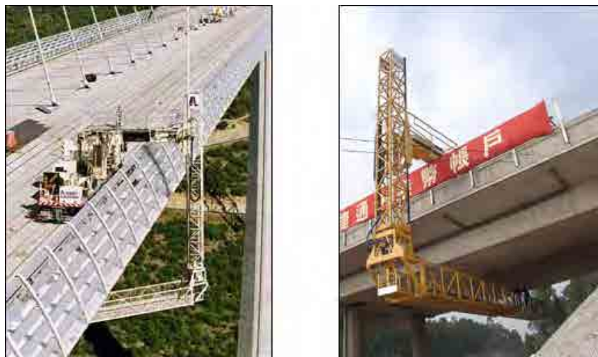
図 5-38 Barin 社(イタリア)の橋梁点検車
