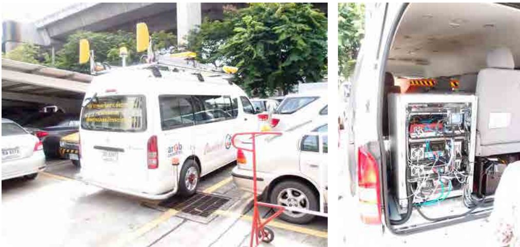
図 5-41 DOH に導入されている路面性状測定車(HawkEye)
