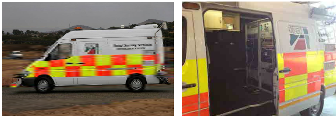
図 5-53 南アフリカ・SANRAL が保有する路面性状測定車
