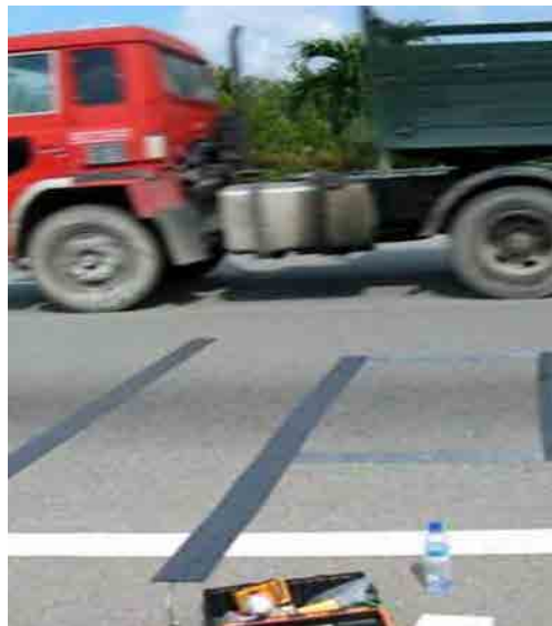
図 5-40 マレーシアに導入されている車両重量計測システムの例
