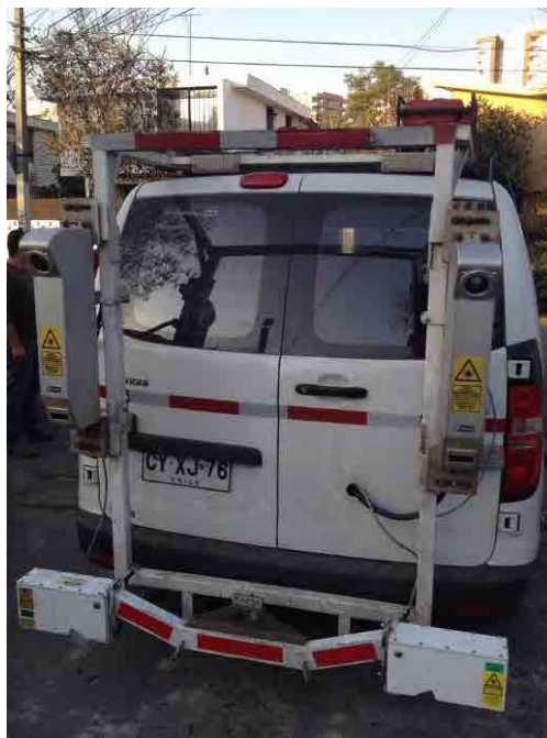
図 5-46 チリ・APSA 社保有の路面性状調査車
