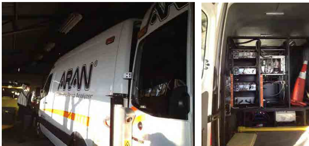
図 5-45 チリ・MOP 研究所の路面性状測定車（ARRAN 製）
