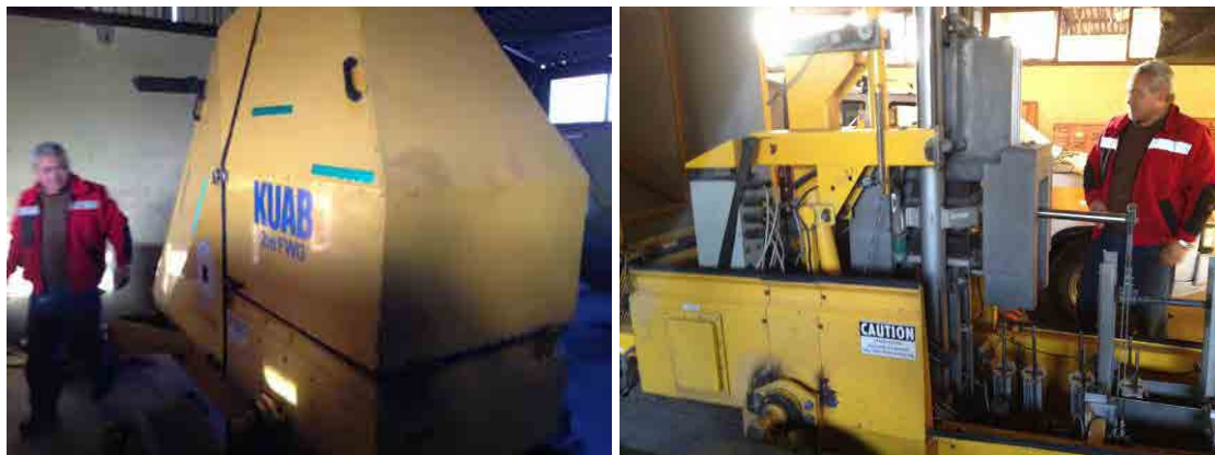
図 5-47 チリ・MOP 研究所の FWD 試験機(KUAB 社製)
