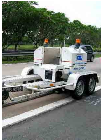
図 5-36 マレーシアに導入されている FWD 測定機材の例
