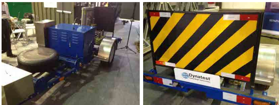
図 5-51 ブラジル・Dynatest 社の FWD 試験機の例
