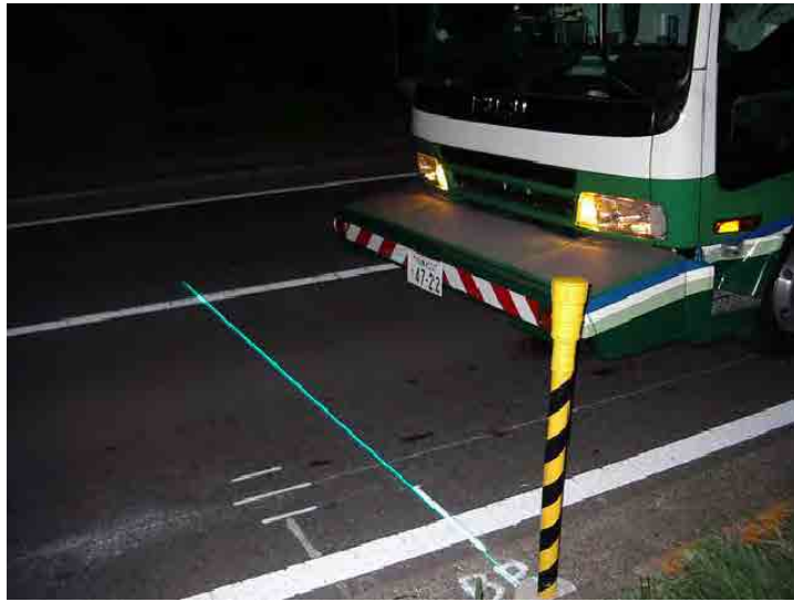
図 5-6 路面性状測定車によるわだち掘れ計測
