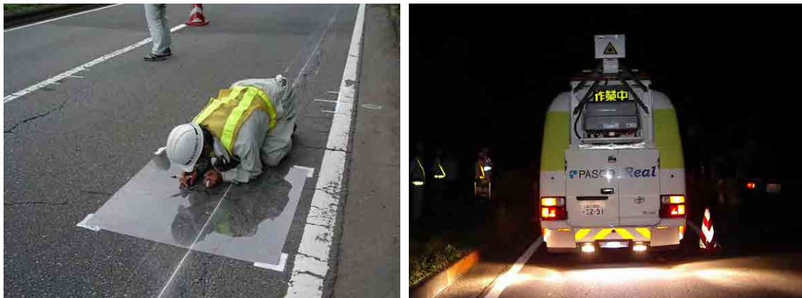
図 5-20 路面性状測定車の性能確認試験の様子
