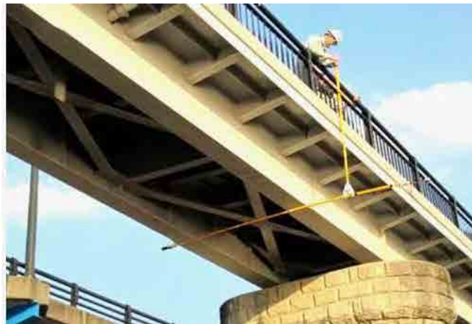
図 5-26 カメラを用いた簡易橋梁点検機の例
