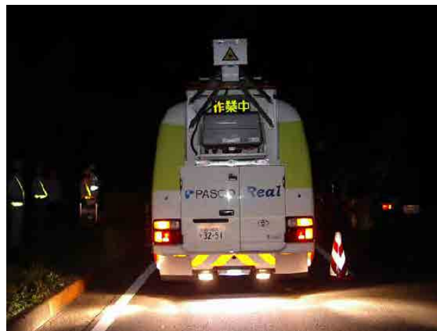
図 5-8 路面性状測定車によるひび割れ計測
