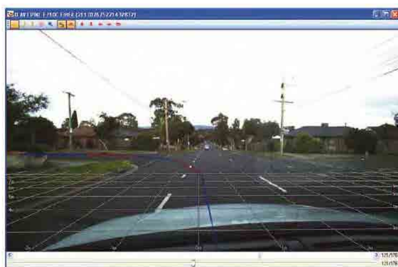
図 5-10 道路画像を用いたひび割れ評価の例
