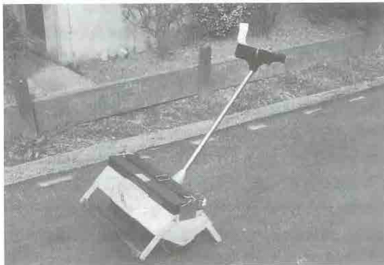
図 5-15 MTM によるテクスチャの測定
