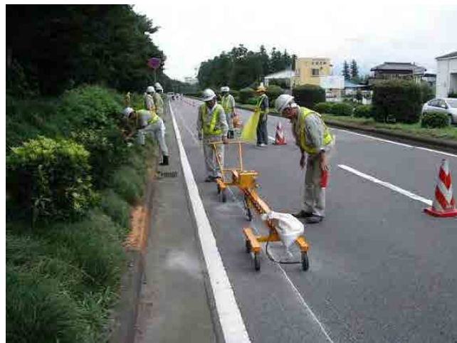
図 5-12 ウォーキング・プロファイラーによる計測
