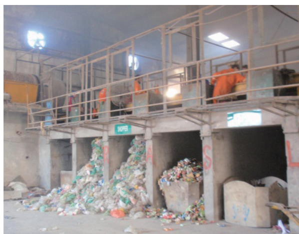
写真 3－47 Waste Busters 社で現在稼働中の分別機
