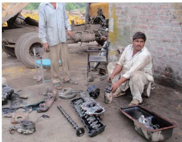
写真 3-40 エンジンの分解修理しているところ
