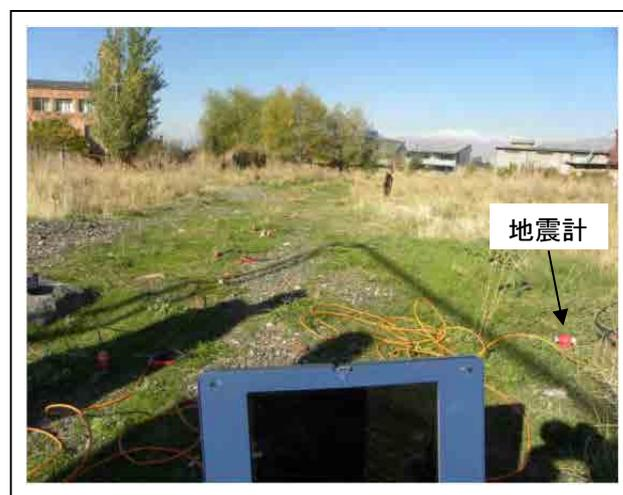
図 3.3-2 表面波探査のL字型地震計配置
