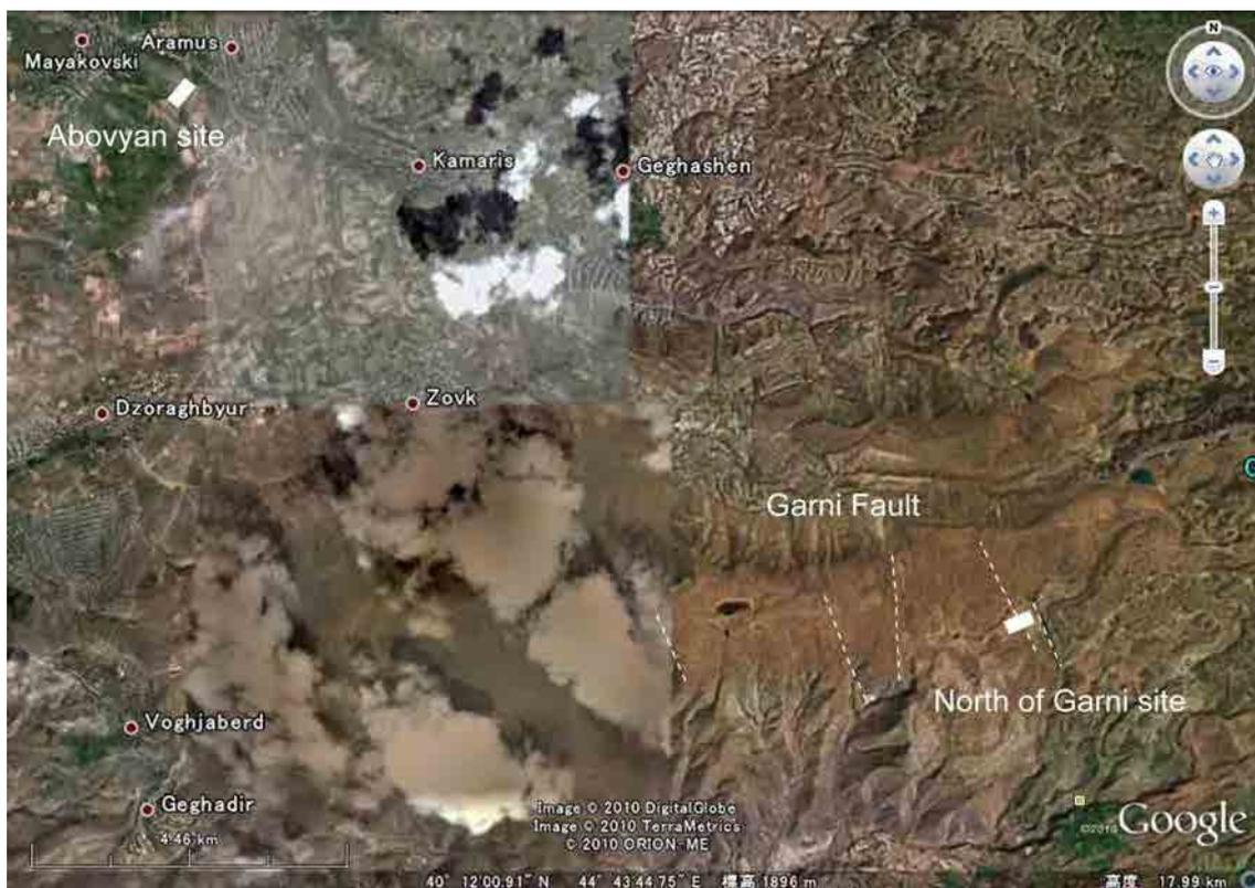
図 3.7-3 Garni 村北方の山頂部にみられる活断層(白い破線) 少なくとも南北の5条の断層がみられる
