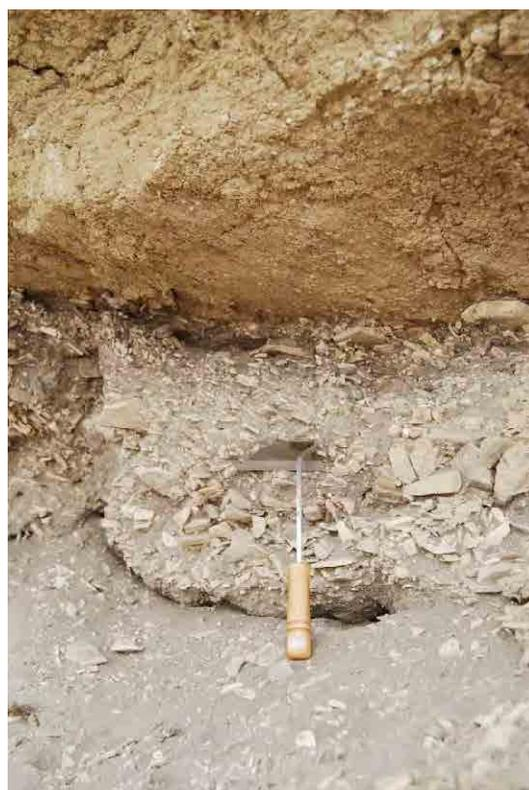
図 3.7-32 断層部の写真 ねじり鎌の部分が未固結の砂礫層。その上部が白亜紀の砂岩であり、断層面にスリッケンサイドがみられる。断層の走向・傾斜は  $N62^{\circ}W, 17^{\circ}NE$  であり、スリッケンサイドの方向は  $N20^{\circ}E$  である
