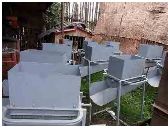
計 24 台のキャッサバカッター（2 台／農民グループ）はアワサ市内の鉄工所で製造した
