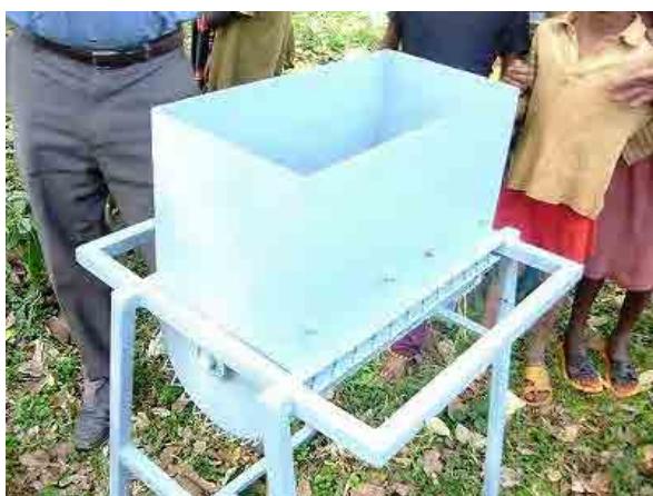
改良された生キャッサバ細断機。本体下部を円形にして細断と排出の効率を上げた。
