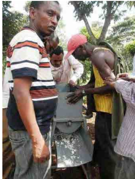
PP04 で開発されたキャッサバ・カッターを試す研修参加者
