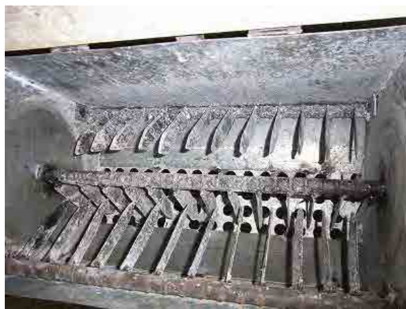
調査団は生キャッサバ細断作業に適すように、コチョコ裁断機を改造した。中央の回転式複数刃と両側に複数の固定刃を取付けて、機械室内の飛び跳ねを防いで効率を良くした。
