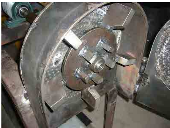
大粒の乾燥キャッサバ粉碎機の開発、ピンミル型を開発して性能確認を実施した。
