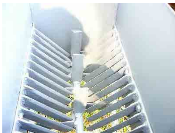
固定刃の取付け角度を 45 度にして、排出を良くした。製作精度を向上させ、回転刃と本体の排出金網の隙間を 5mm にした。
