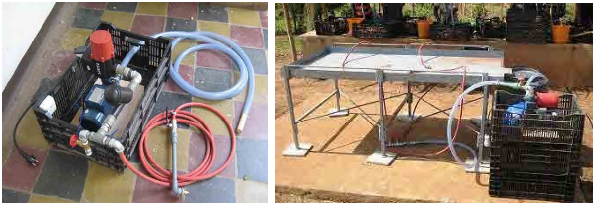
「定圧ポンプ+ノズル仕上げ洗浄」及び「ノズル洗浄用水の循環使用」の機材
