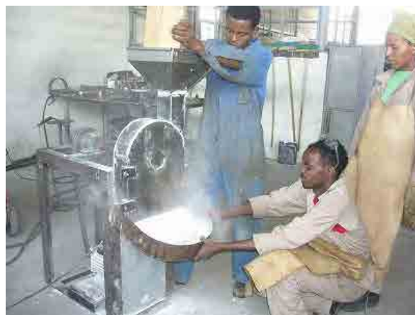
小粒のキャッサバ粒だけでなく、多くの粉が発生するためこのタイプは中止した。
