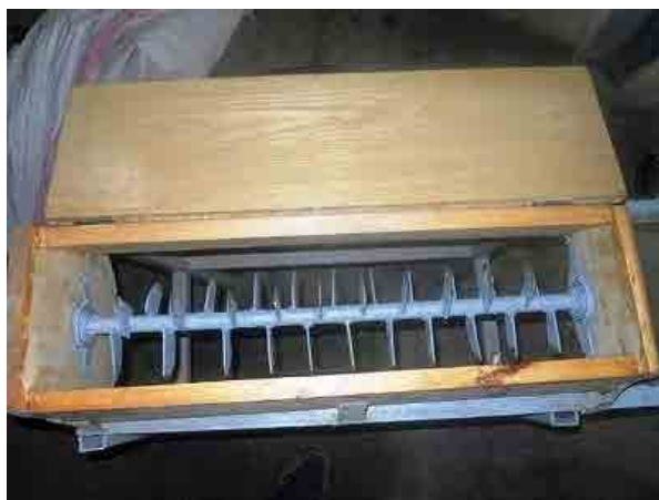
アワサ大学が開発したコチョコ裁断機。回転式の複数ナイフが特徴。バッチ式のため連続運転は出来ない。
