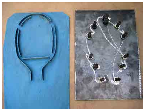
左：鉄筋曲げ加工と溶接作業用モールド
