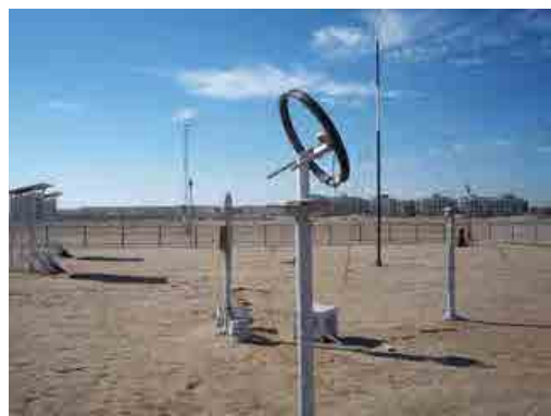
写真 3-1-3-2 ハルガダ気象台日射量計群 (手前: 散乱日射量計、奥: 全天日射量計)
