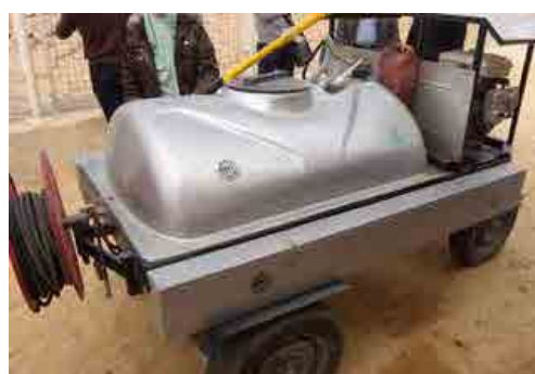
写真 2-2-14 太陽光モジュール清掃用高圧洗浄機
