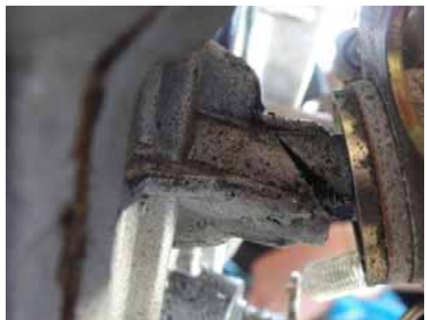
マヌス州：精米機エンジンケーシングの破損
