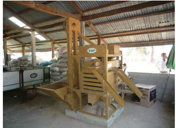
チェン村の採種農家グループのラオスで開発されたラオス製選別機
