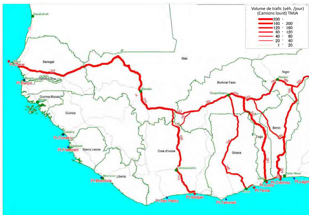
Figure 5-10 Volume du trafic de camions lourd au départ ou à l'arrivée de 3 pays sans littoral
