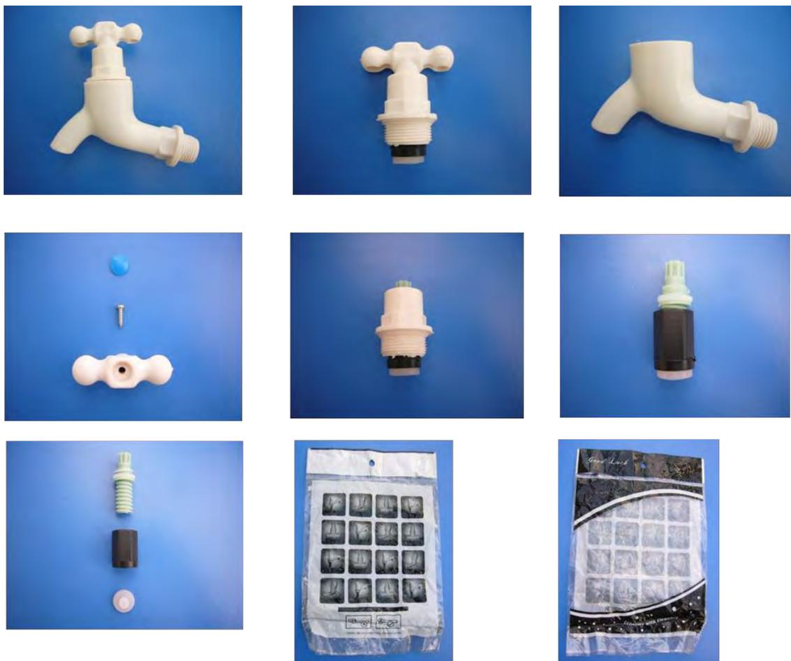
商品ブランド名は **GOOD LUCK**、試験結果は  $0.4\text{Mpa}$ （水頭約 40 メートル）までの止水性能を確認、コロambo（最大水頭 15 メートル）における止水性能には問題が無い事が判明した。（ただし、流水時における水栓の上部からの漏れを確認した）（写真参照）
