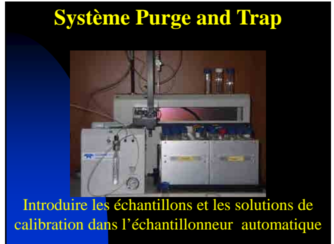
« Purge and Trap » couplé à un chromatographe en phase gazeuse et à un spectromètre de masse.
