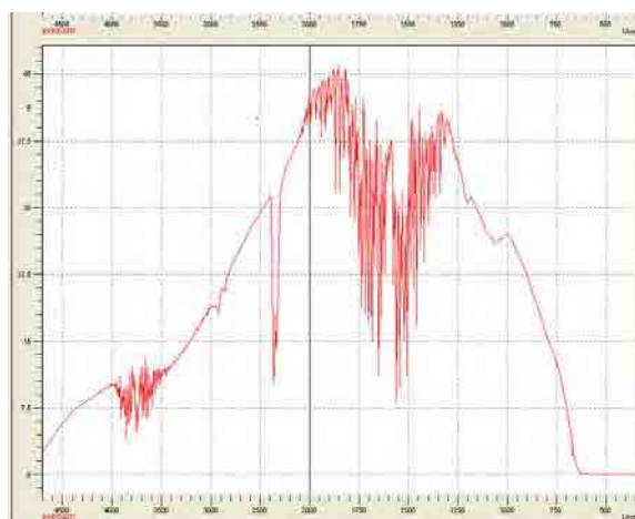
Figure 2 Spectre fond d'absorbance ou power spectrum (BKG) pour la méthode ATR
