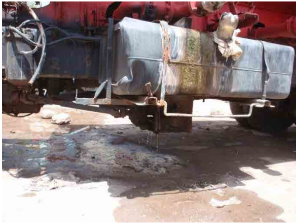
La fuite d'eau du camion-citerne en action. La corrosion provoquée par l'eau du robinet contenant le sel étant importante, l'eau fuit par les tuyaux ou les joints.
