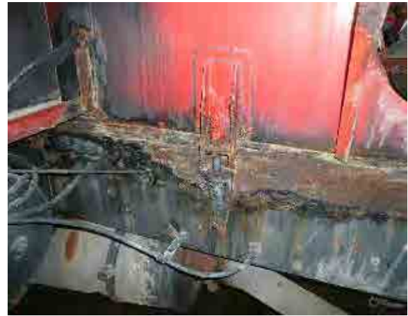
L'état de rouille du camion-citerne. On observe la rouille même sur le châssis qui a une importance sur la rigidité du véhicule.
