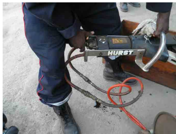
L'équipement hydraulique de sauvetage en essai. En ayant la fuite d'huile, on ne peut pas l'utiliser pour le sauvetage.
