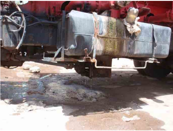
消火活動中の水槽車の漏水。塩分を含む水道水のため腐食が激しく、配管部等から漏水している。
