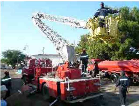
試運転中の空中作業車。経年使用のため、車体や塔体の振動が激しく、実際の消防活動上には危険である。
