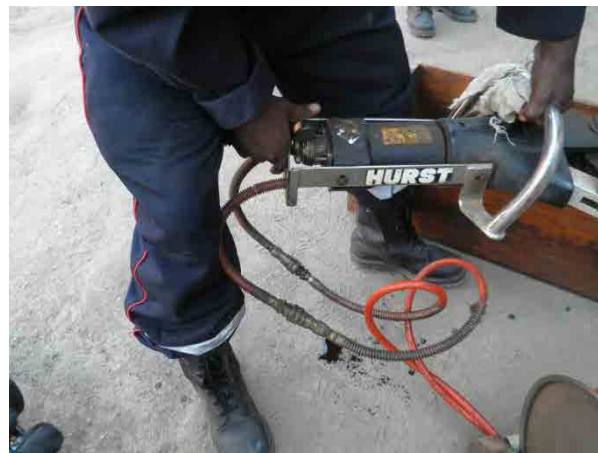
試運転中の油圧式救助器具。油漏れ等があり、実際の消防活動には使用できない。
