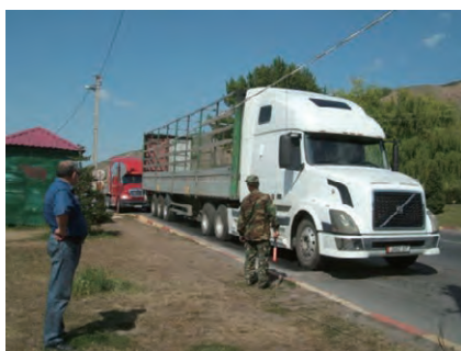
大型トラック（全長17m, WB14.45mで載台（14.8m）ぎりぎり）
