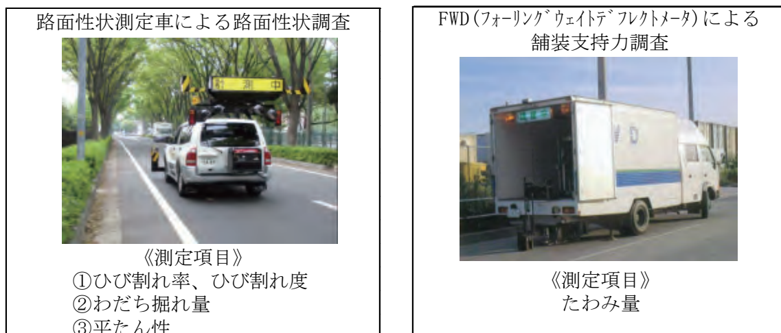
写真- 75 路面性状測定・たわみ量測定機器の一例
