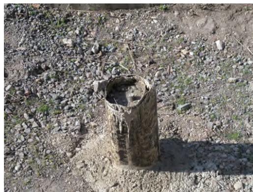
設置したベンチマーク
