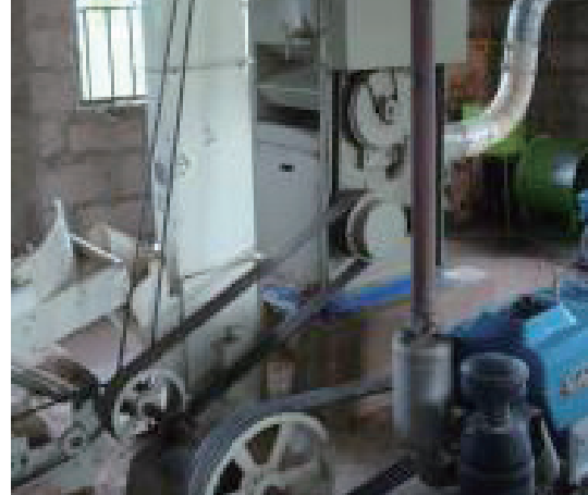
ワンパス精米機を使用した機械組 手前左に粗選機、昇降機が見られる。 (NFRA の研修機材)
