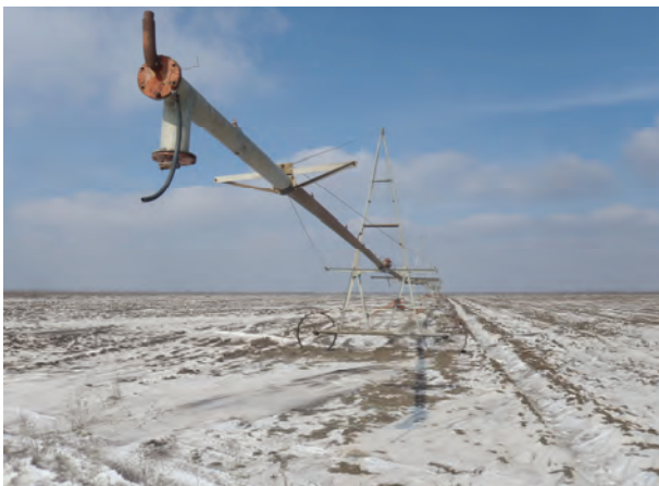
Freedom Farm 農場灌漑地におけるピボット灌漑施設(油圧式:半径 500m)
