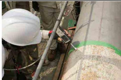
写真 3-16 ペーストの水分量測定
