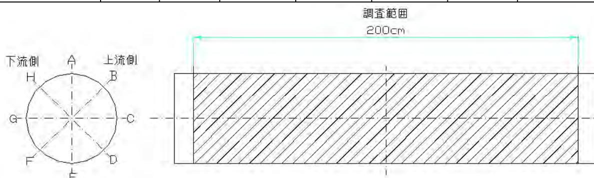
図 3-4 ケーブル塗膜外観測定箇所
