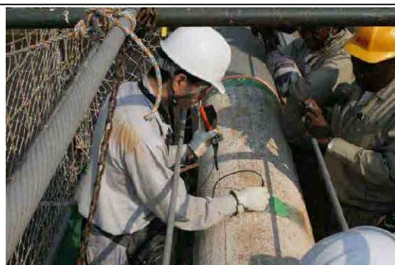
写真 3-26 亜鉛メッキ厚の測定、更に詳しくは添付レポート参照。
