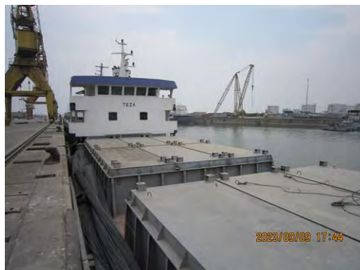
Photo 3.16 : Garnitures de conteneurs sur la couverture de trappe du "MV Teza"
