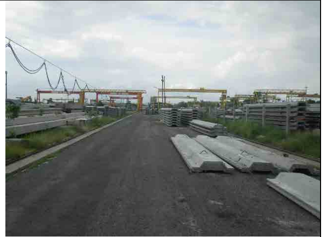
サラブリー県にある S 社のコンクリート二次製品の製作工場。JIS 規格の波形コンクリート矢板の調達が可能である。
