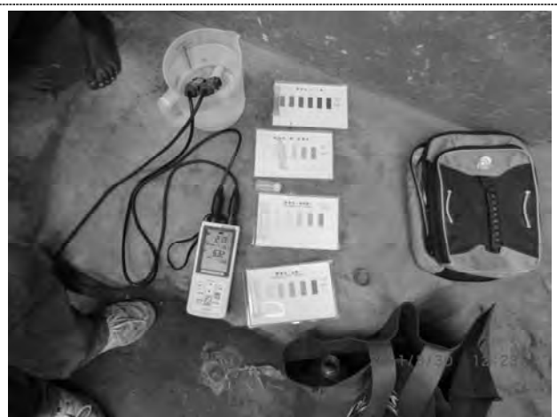
既存井戸の簡易水質調査状況-温度 26.0、pH6.33、EC21.8mS/m、フッ素 0mg/L、硝酸 0mg/L、亜硝酸 0.02mg/L、鉄 0.3mg/L で問題なし。(ウニヤマ RGC)
