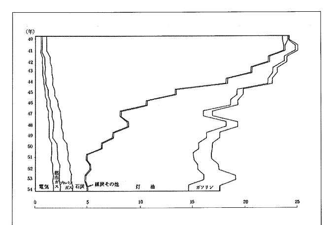
「北海道においては、昭和 40 年当時総エネルギーの 90%を占めていた石炭が、昭和 54 年には 8%に縮小し、灯油がこれに代わった。北海道では暖房用に使用 されていた石炭が灯油に代わり、石炭ストーブの燃焼制御の困難さからくる温度管理の難しさと、煙突からの多量の熱損失が改善され、熱効率が上った・・」
