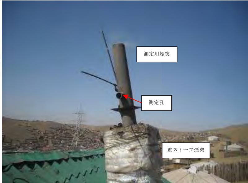
図 4-28 壁ストーブ測定状況
