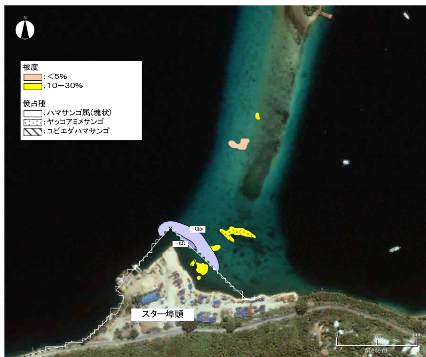
図 7.1.2-3 サンゴ礁の分布と流速変化値図の重ね合わせ（上げ潮時）
