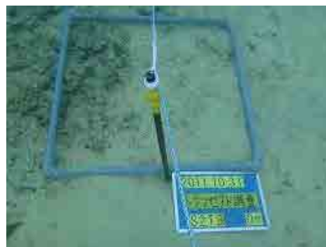
写真 5.1.2-2 設置後の鉄杭の状況
