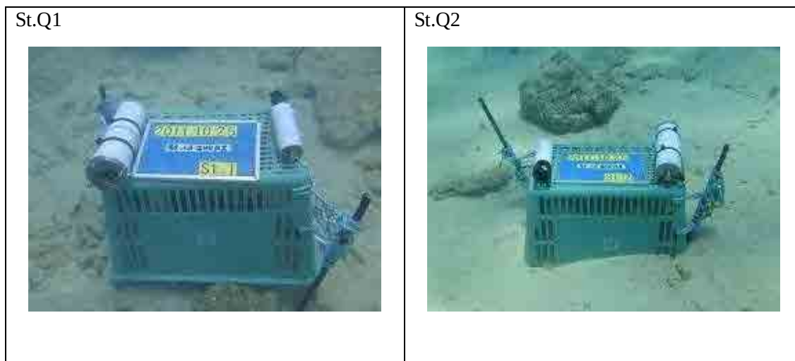
写真 5.1.3-2 自記式測定器の設置後の状況
