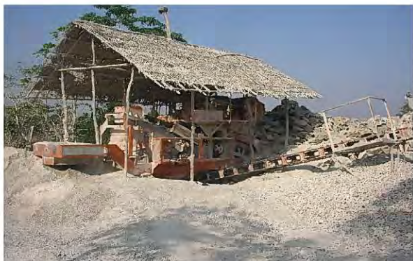
写真-3-2-9 砕石場（日本製破碎機）
