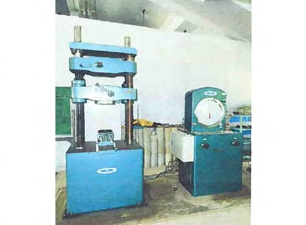
写真 12: 鉄筋の曲げ、引張り試験機 1988 年に納品され、油圧パイプに漏れがある。メーカーによる点検・調整は為されていない。(2012/01/16)
