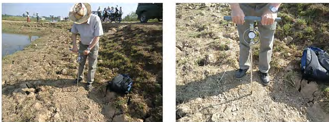
写真-3-2-1 コーン貫入試験状況
