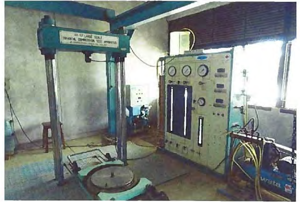
写真 10: 大型三軸試験機: \phi 300 mm 1988 年に納品され、間隙水圧計に一部故障ヶ所がある。メーカーによる点検・調整はされていない。(2012/01/16)
