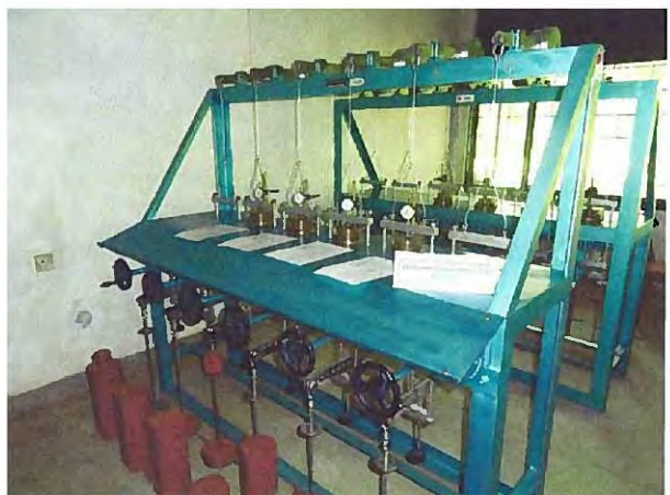
写真 11: 圧密試験機: 6 連 1988 年に納品され、丁寧に使われているが、計器の一部が故障している。メーカーによる点検・調整は為されていない。(2012/01/16)
