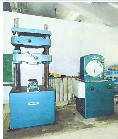
写真 12: 鉄筋の曲げ、引張り試験機 1988 年に納品され、油圧パイプに漏れがある。メーカーによる点検・調整は為されていない。(2012/01/16)
