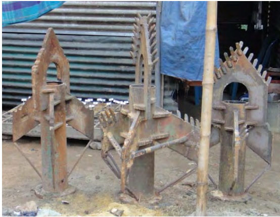
図 3.2.2 砂礫・粘土層掘削のためのブレードビット (バングラデシュ民間掘削業者製作)
