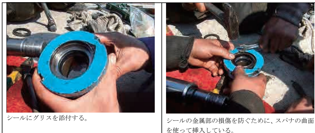
図 2.4: シリンダーヘッドのシール交換
