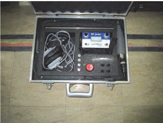
Executive Engineer Office にある音聴式漏水探 知機 (フランス製)
