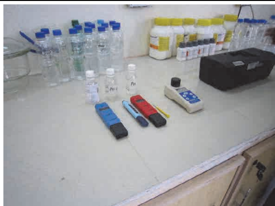
水質試験室にある携帯型水質試験器 (濁度計、pH 計、電気伝導度計)
