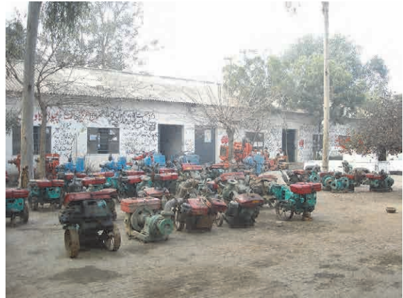
可搬式排水ポンプ。ポンプ場に併設されたワー クショップで、保守・点検を行っている。
