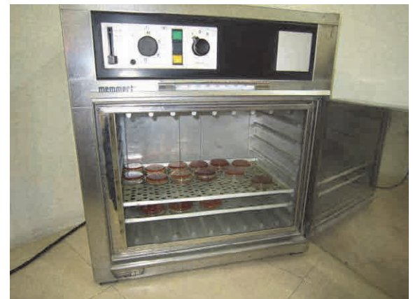
水質試験室の細菌培養用のインキュベーター （生物試験実施可）
