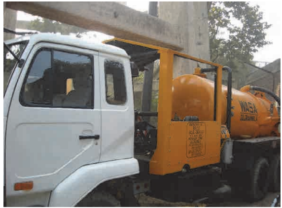
下水管の高圧洗浄車 （良好に保守・点検を行っている）
