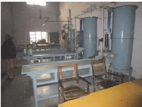
No.1 下水ポンプ場に併設したワークショップ にある量水器用のテストベンチ
