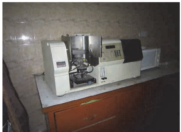
No.1 下水ポンプ場に併設した水質試験室にあ る原子吸光光度計 (現在使用不可)
