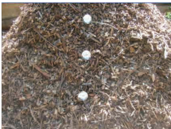
堆積の温度計測
