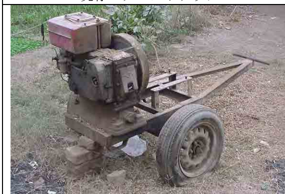
既存の排水ポンプセット
