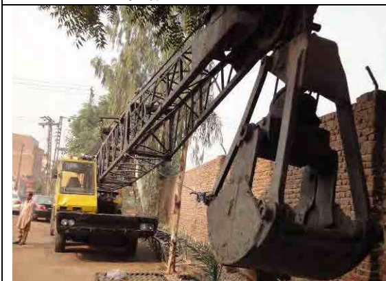
既存のバケット・クレーン
