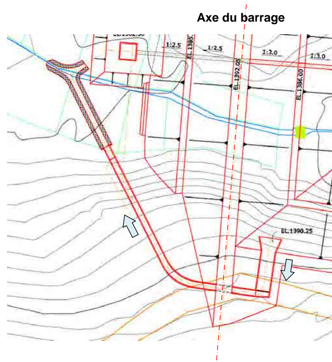
Fig. 4-1-2-30 Vue générale en plan de l'évacuateur de crues
