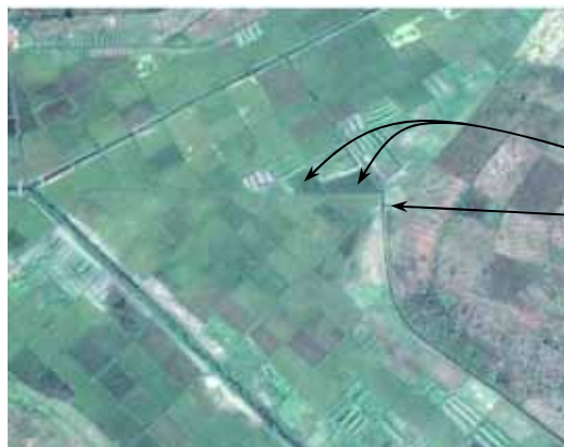
右岸山裾沿いの水路が Ngoma-22 側へと回り込んでいるように見えるが、水路は手入れがなされており、水は流れていない。
